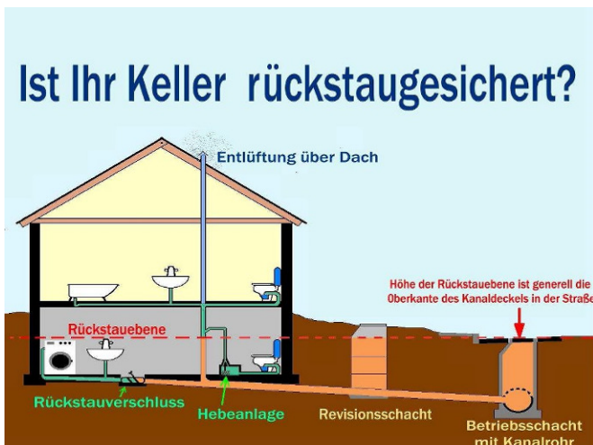
Abb.: die „Rückstauverschlusseinheit“ ist im Regelfall die Straßenoberkante. Die Entlüftung der Abwasserrohre auf dem Dach wird oft mit einem kleinen Schornstein verwechselt.
