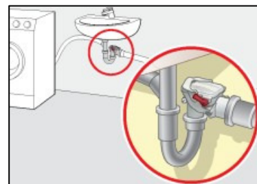
Abb.: Mini-Rückstausicherung am Siphon-Ablauf (Quelle: Kessel)
