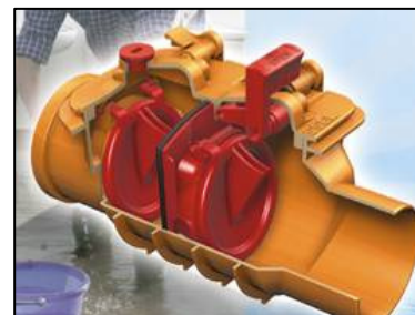
Abb.: das Innere einer Rückstausicherung für fäkalienfreies Abwasser. Die Rückstauklappen öffnen nur in Abflussrichtung. Von außen eindringendes Wasser wird dagegen gesperrt (Quelle: Kessel)
