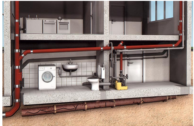
Abb.: Erneuerung einer schwer zugänglichen Leitung durch Stilllegen des Altröhres und Abhängen der neuen Leitung unterhalb der Decke (Quelle: Jung Pumpen)
